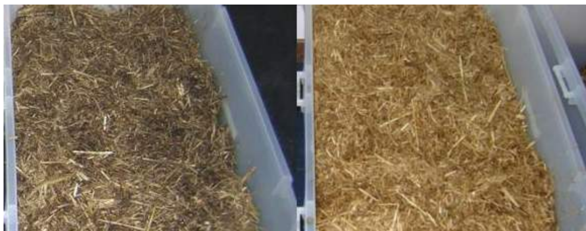
Figura 2. Cumuli (5 Kg) di trinciato di paglia inoculati con il biofermentato di acque di vegetazione, in prove di compostaggio su scala di laboratorio.
